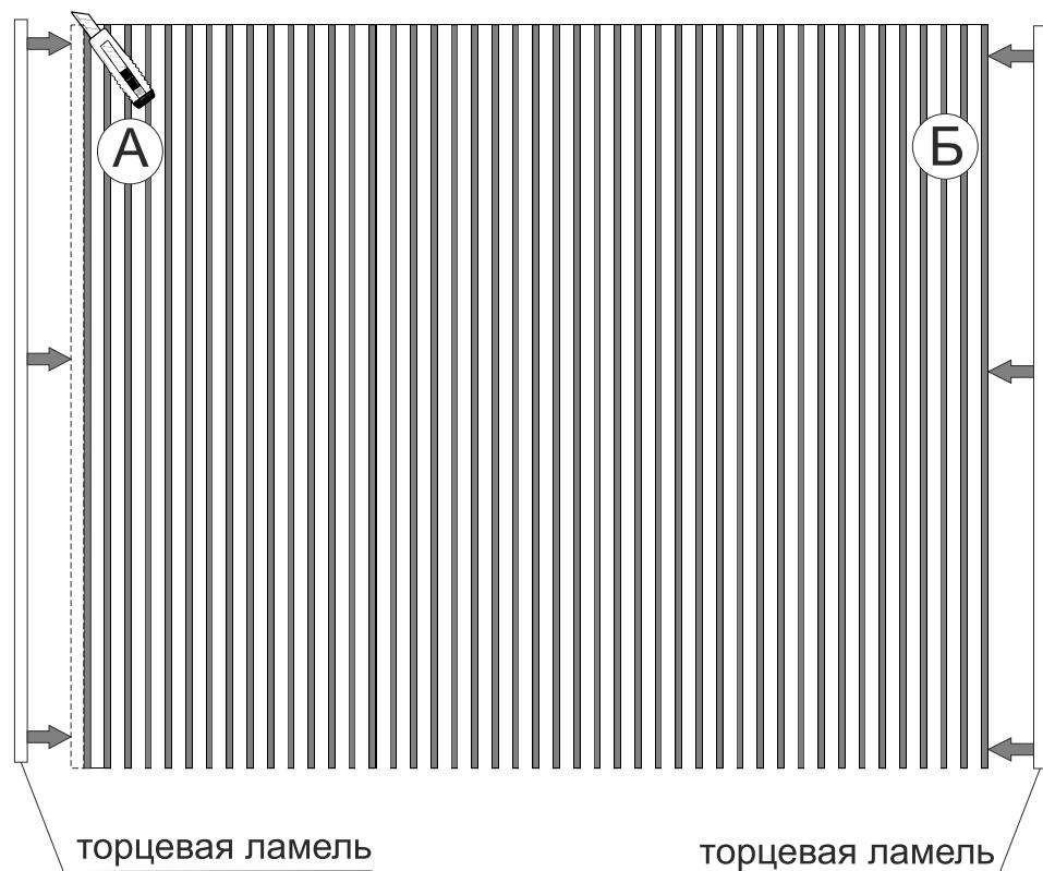
Отрежте крайнюю ламель со стороны «А», оставив при этом край фетра 13мм. Замените отрезанную ламель торцевой ламелью, которая имеет размер 22x27мм. тем самым закройте торец панели
