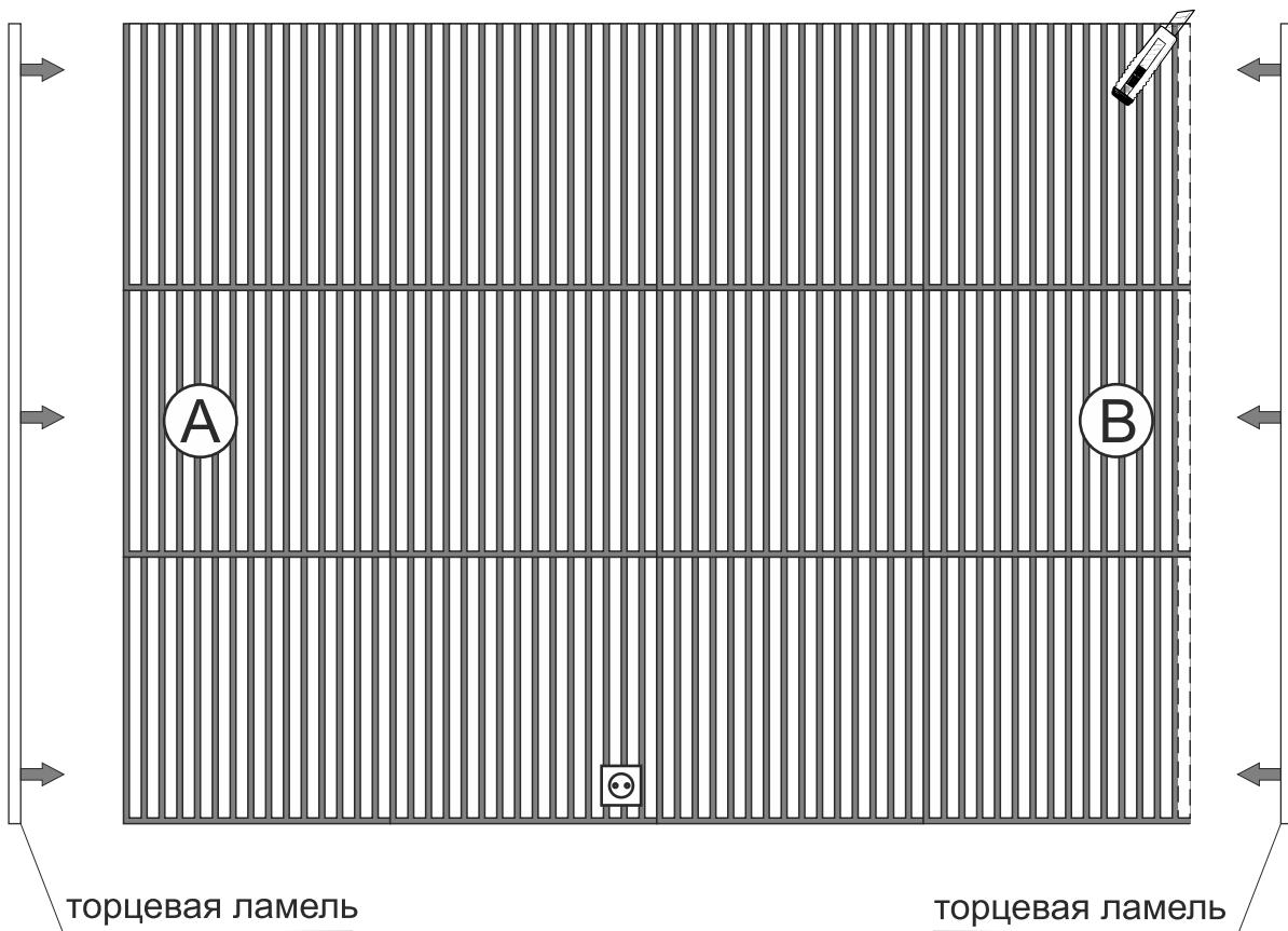
Отрежте крайние ламели со стороны «В», оставив при этом край фетра 13мм. Замените отрезанные ламели торцевой ламелью, которая имеет размер 22x27мм. тем самым закройте торцы панелей
